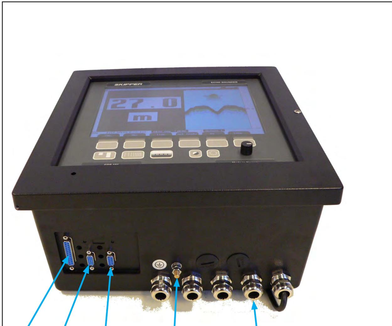
Ground Stud 5 x PG 13,5 cable entry 10-12 mm
